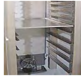
Ventilateurs intérieurs assurant la répartition uniforme de l'air froid.
