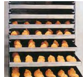
Structure intérieure de 15 jeux de guides pour placer des plateaux de 40x60.
