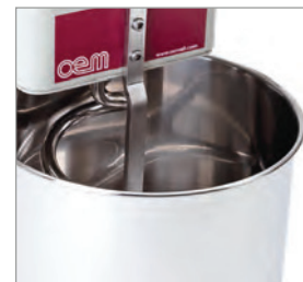
Agitateur en spirale permettant de pétrir un grand volume de pâte et assurant un processus d'oxygénation optimale du produit.
