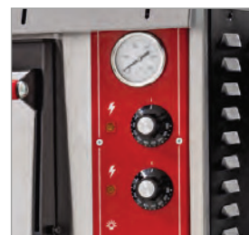
Contrôle électromécanique de la température.
