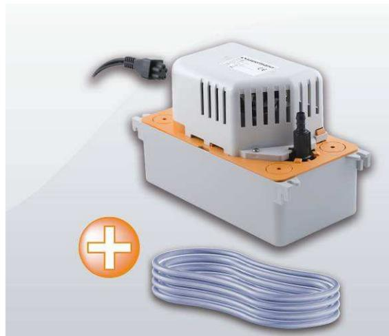
La pompe Si-82 est conçue pour faciliter son installation dans tout type de conditions. Pouvant évacuer jusqu'à 500 l/h, elle convient aux appareils d'air conditionné et de réfrigération. Résistante, la Si-82 tolère parfaitement les condensats chargés, haute température et acides (pH>2.5) produits par les chaudières à condensation gaz.
