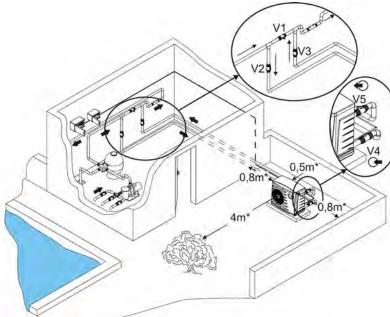
V1-2-3 : vanne de by-pass V4 : vanne d'entrée d'eau V5 : vanne de sortie d'eau \* distance minimum
