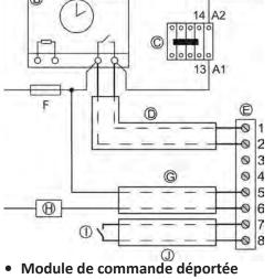
A1-A2 : alimentation de la bobine du contacteur de puissance de la pompe de filtration
